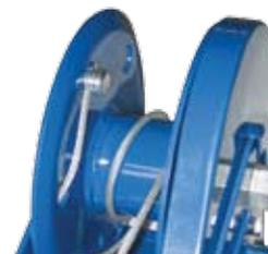
Namatanje čeličnog užeta je vrlo jednostavno samo treba pripaziti na raspored užeta, a kod otpuštanja tereta uvijek bi trebali ostati 2-3 namota užeta.
